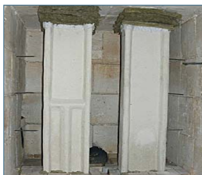
Рисунок 2. Пример расположения образца колонны, испытываемой под нагрузкой
