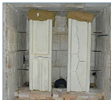
Рисунок 2. Пример расположения образца колонны, испытываемой под нагрузкой
