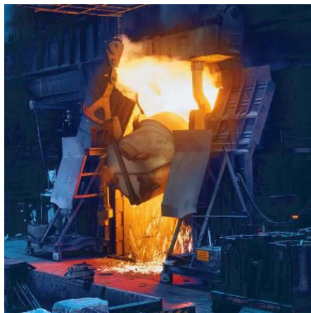
Выплавка стали в кислородном конвертере
