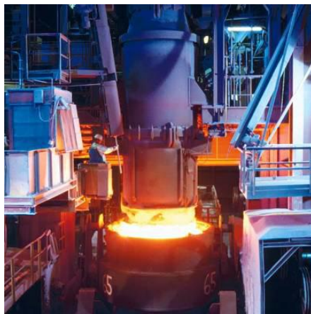
Внепечная обработка стали
