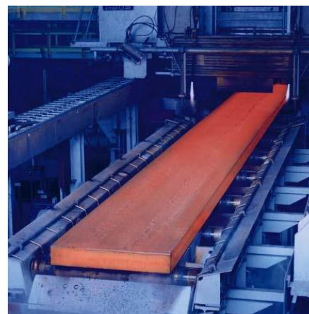
Разливка стали на МНЛЗ
