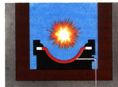
5. Формовка взрывом
