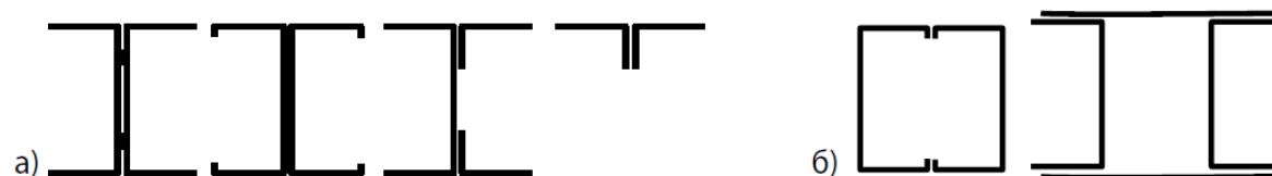
Рисунок 1.4 – Составные профили: а – открытого сечения; б – закрытого сечения
