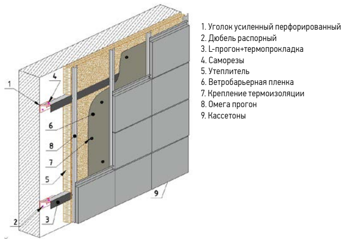
Структура навесного вентилируемого фасада из фасадных кассет
