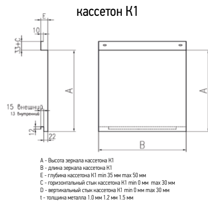
Пример чертежа-схемы фасадной кассеты K1 с закрытым стыком, компания «Прушиньски»
