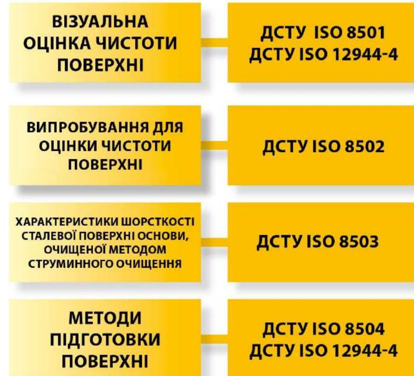
**ДСТУ ISO 12944-4.** Частина 4. Типи поверхні та підготовка поверхні.
